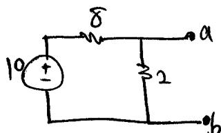
۷. ولتاژ تونن  $V_{ab}$  چقدر است؟
