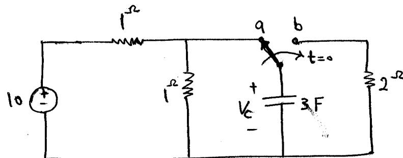
۳. در مدار زیر کلید به مدت طولانی باز بوده است. در  $t = 0$  بسته می‌شود. تغییرات ولتاژ  $V_C(t)$  را برای  $t \geq 0$  بیابید.
