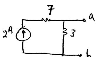
۸. ولتاژ تونن  $V_{ab}$  چقدر است؟
